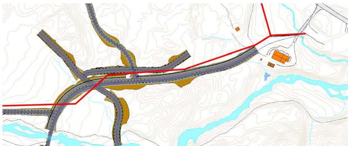
Figur 10 Ny veg og løype struktur sett sammen med eksisterende VA-ledning i rødt
