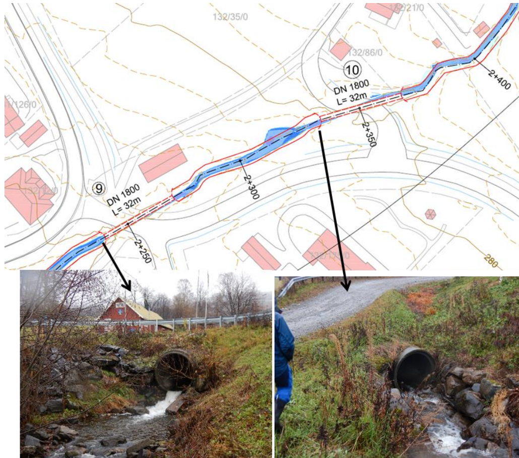
Figur 4.7: Stikkrenner pr. ca. 2350 und 2250
