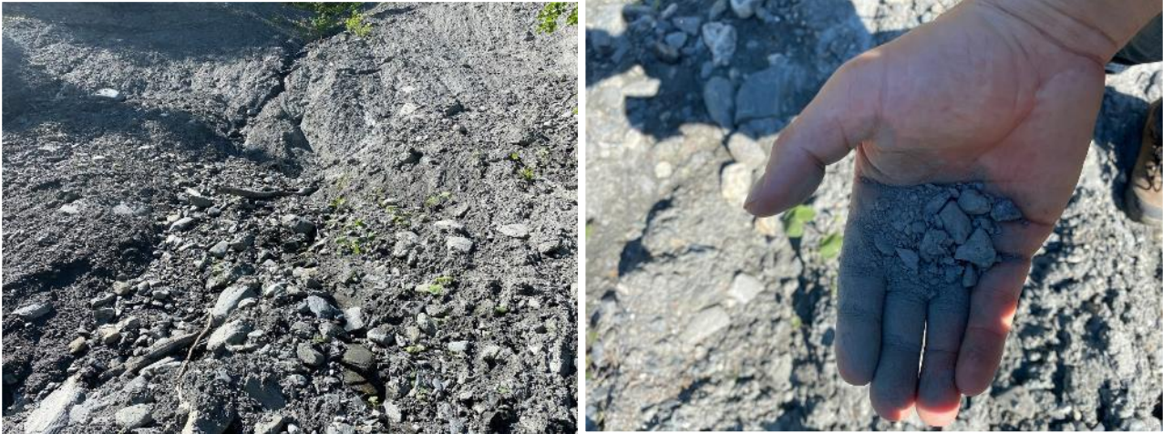
Figur 22. Venstre: Nærbilde av skråning tyder på at det ofte går mindre ras ved høy nedbør; høyre: massene består av hovedsakelig av morenemateriale, alt fra leire til større blokk / elvestein.
