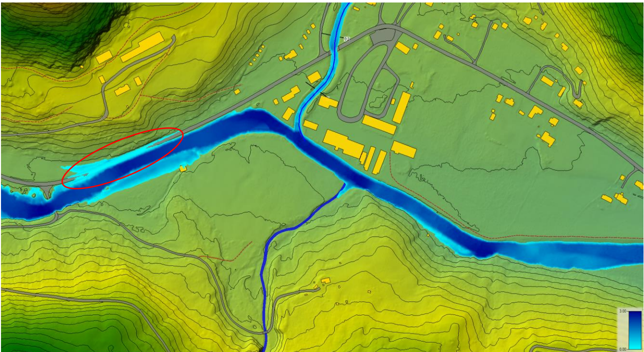
Figur 4. Resultater av vannlinjeberegning for en 5-års flom i Jøra ( Q_{JØRA} = 154 \text{ m}^3/\text{s} ).
