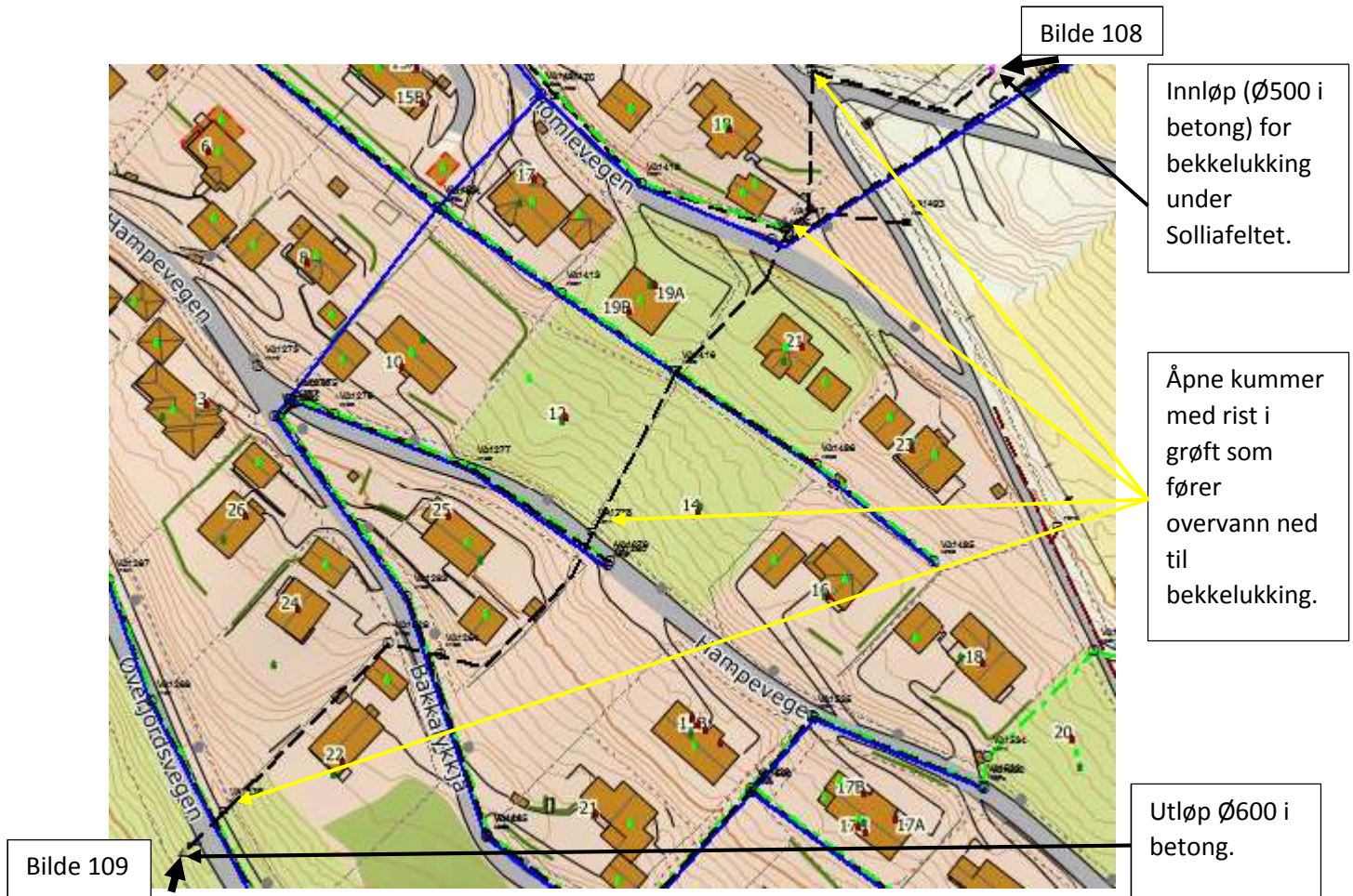
Figur 36. Bekkelukking (svart stiplet linje) under Solliafeltet med innløp ovenfor Gamle Gausdalsveg og utløp nedenfor Øverjordsvegen. Fra Gemini VA.
