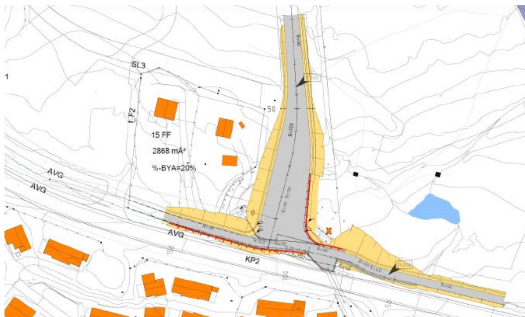
Figur 14 Forkastet løsning, der g/s-vegen er lagt nedenom kulverten.
