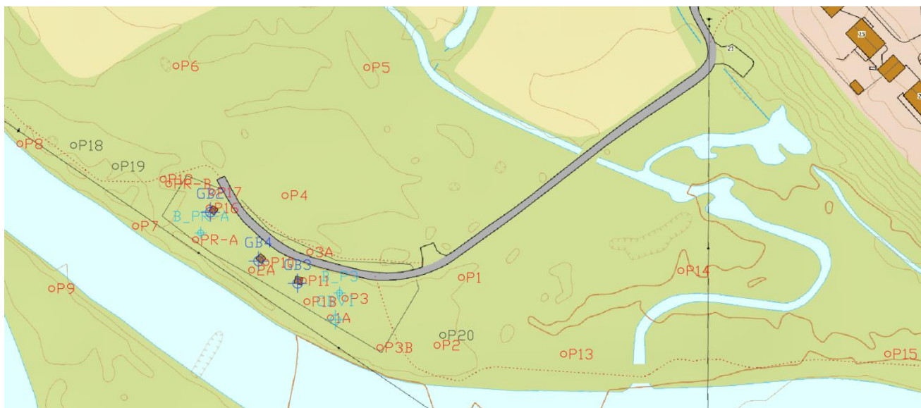
Figur 2. Detaljkart over brønnfeltet på Hyttøya. Aktive produksjonsbrønner (GB2, GB4, GB3) i blått. Nye prøvebrønner P18, P19 og P20 boret i oktober 2020 er vist med sort. Produksjonsbrønner som ikke er i drift i lys blå, og øvrige peilerør i rødt.
