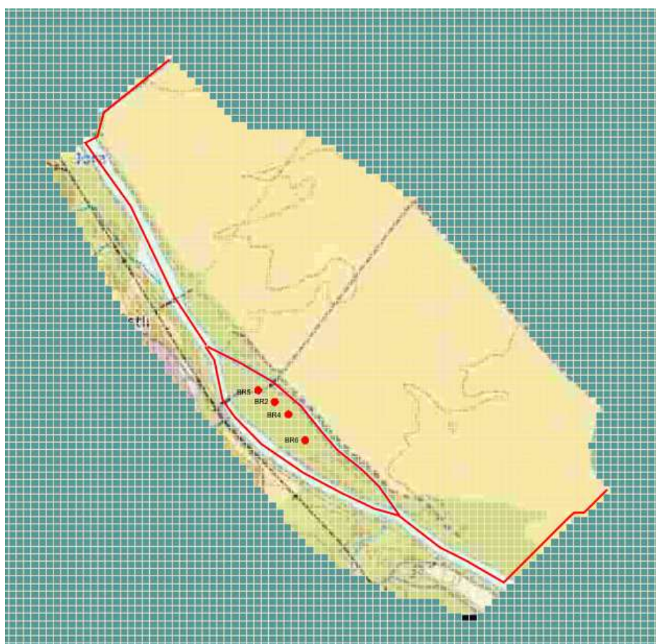
Figur 5 Lag-visning av modellen som viser grensebetingelser tildelt modellen i forskjellige scenarier; røde linjer – Constant Head grensebetingelse, røde punkter – Wells grensebetingelse.
