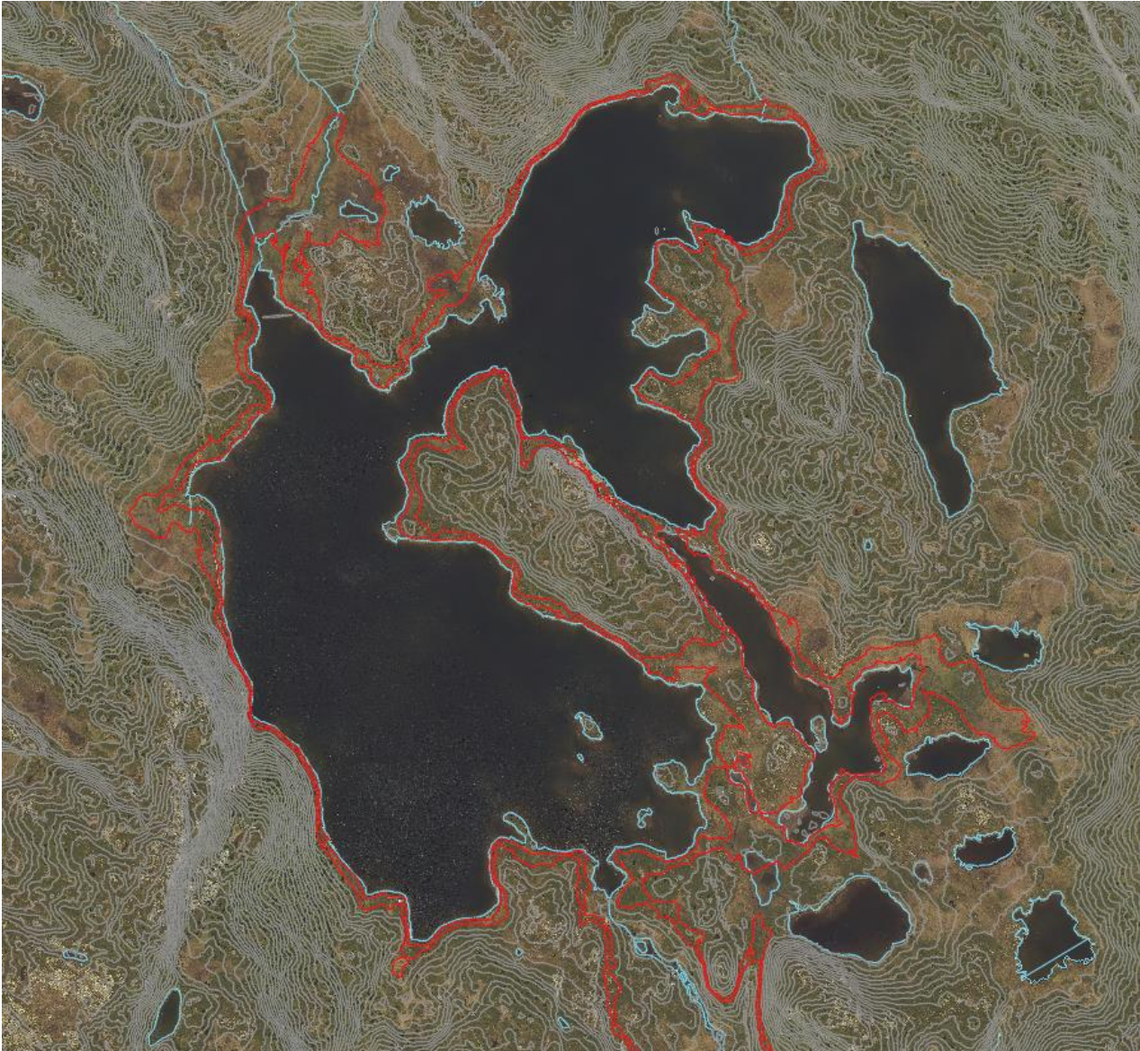
Figur 2-2 Viser konsekvenser ved oppdemning. De røde linjene ligger på kote 926 og 927. Nåværende vannstand i Nisjuvatnet er ca. kote 925,2 moh. Den blå linjen viser nåværende vannkant.
