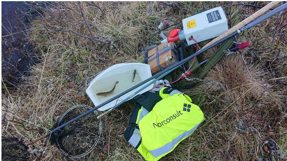
Figur 25. Ryggbært el.fiskeapparat benyttes for registrering av fisk i grunne elver og bekker. Foto: Atle Rustadbakken
