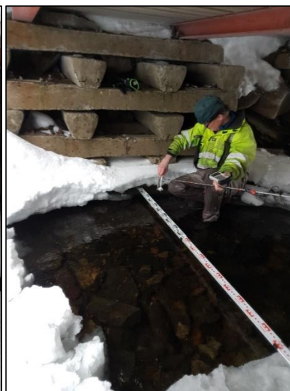
Vedlegg 2 Vannføringsmåling i Nisjua ca. 25 meter ovenfor samløpet med Skeiselva under løpetrasébruen. Q_{m\ddot{a}lt} = 41,5 l/s.
