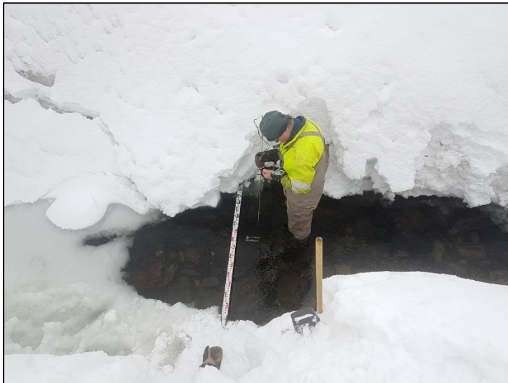
Vedlegg 1 Vannføringsmåling i Skeiselva, ca. 10 meter ndf. Bru. Q_{m\ddot{a}lt} = 76 l/s.
